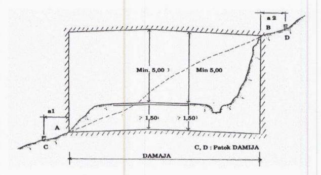
al, a2 : Pengaman jalan (lereng) yang ditetapkan oleh Pembina Jalan berdasarkan sifat material dan konstruksi jalan setempat.
